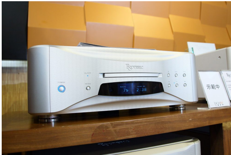
旗艦 SACD/CD 機 K1 搭載了獨有 VRDS-NEO 雷射機芯，有效減低讀碟時的抖動及失真。至於其穩定的供電架構及超線性解碼「專用 ES-Link」亦是本作焦點所在。
