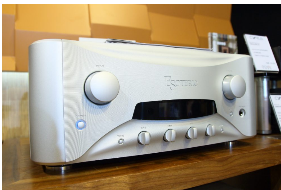
合併式擴音機 F1 配有專用 ES-Link、全平衡推挽式 A 類放大模組，搭載 QVCS 精確音量控制和 DSD / DXD 解碼模組。
